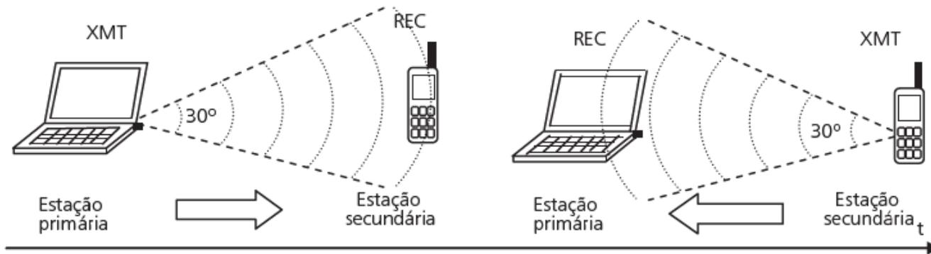
**figura 3.25** Nível físico da WPAN IrDA: exemplo de conexão ponto-a-ponto entre dois dispositivos IrDA operando em modo semiduplex.
