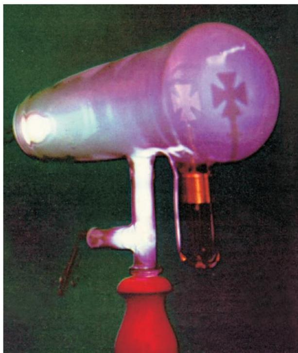
O tubo de descarga em gás da foto é a Ampola de Crookes. Os elétrons escapam do catodo (à esquerda) e movem-se para o anodo (à direita) em linha reta. Como os elétrons não atravessam a cruz de metal, aparece a sombra desta na parede da ampola.
